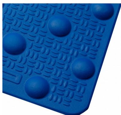
Conformément à la loi sur l'accessibilité des ERP et de la voirie, cette dalle podotactile doit être collée à 50 cm des bords de quais, des passages piétons et de la 1ère marche du haut de chaque palier d'escalier. A coller à l'aide d'une colle bi-composante, sa mise en service sera possible 24h après la pose.
