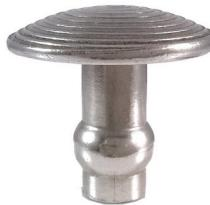
Le kit de clous podotactiles sans scellement est composé de 100 clous inox et un gabarit de pose. Il permet de créer des bandes d'éveil à la vigilance conformes à la loi accessibilité (prévoir 147 clous par mètre linéaire).
