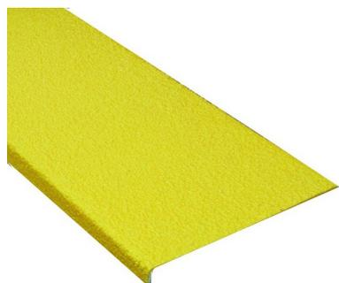
Le nez de marche antidérapant large en fibre de verre (230 mm) convient aussi bien aux escaliers intérieurs qu'extérieurs et se fixe à l'aide de vis (non incluses). La version pour trafic modéré mesure 3,8 mm d'épaisseur et celle pour trafic intense 4,2 mm.
