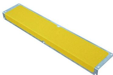
Le nez de marche pour escalier comporte 8 à 10 trous pré-perçés pour une fixation par vis (non incluses). Il peut être utilisé en intérieur ou en extérieur et présente une bonne résistance face aux UV, aux intempéries, au froid et aux graisses. La bande antidérapante se remplace facilement en cas d'usure.
