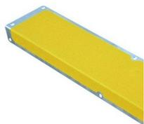
Le nez de marche pour escalier comporte 8 à 10 trous pré-perçés pour une fixation par vis (non incluses). Il peut être utilisé en intérieur ou en extérieur et présente une bonne résistance face aux UV, aux intempéries, au froid et aux graisses. La bande antidérapante se remplace facilement en cas d'usure.
