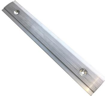
Le profil antidérapant permet de sécuriser les passerelles métalliques, minérales, bois ou composites. Pour rendre une passerelle antidérapante, il est nécessaire d'espacer les profils de 20 cm.
